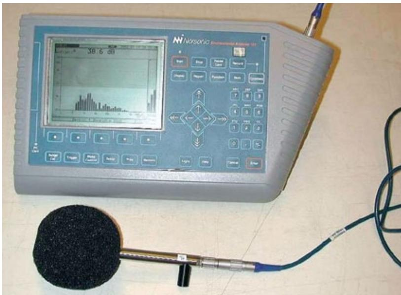
Abb. 2/11 Modernes Schallpegelmessgerät
